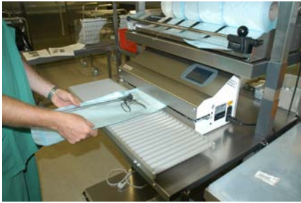
Abb. 1: Normkonforme Siegelgeräte überwachen die kritischen Prozessparameter automatisch. Sollte ein Parameter über den Grenzwert hinaus abweichen (z. B. \pm 5^\circ\text{C} ), alarmieren sie den Anwender.
