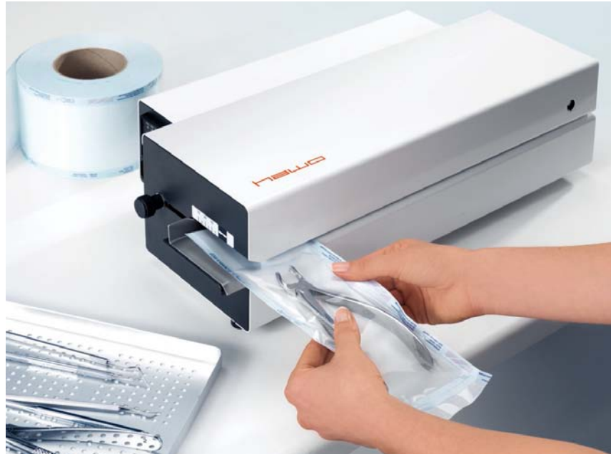
Modernes, voll validierbares Siegelgerät mit Drucker
