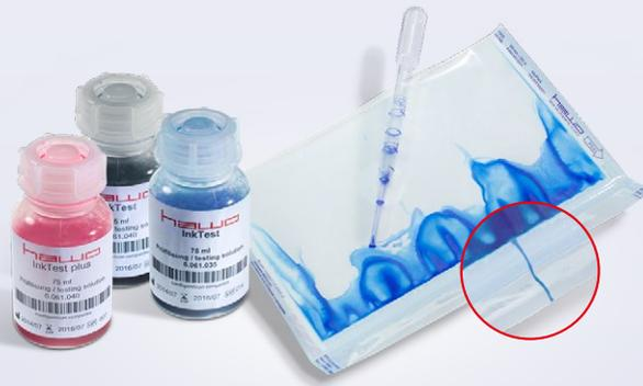
Der hawo InkTest kommt in einer 75-ml-Flasche zusammen mit Pipetten und einem Abtropfbehälter.
